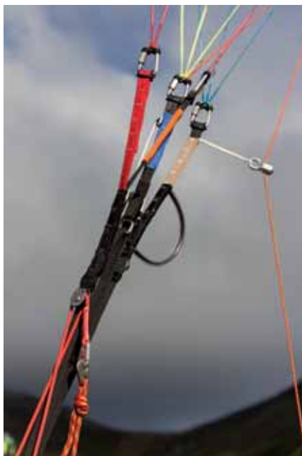
Les élévateurs, avec la belle poignée de pilotage sur les C qui agit aussi sur les B via un système de renvoi.
